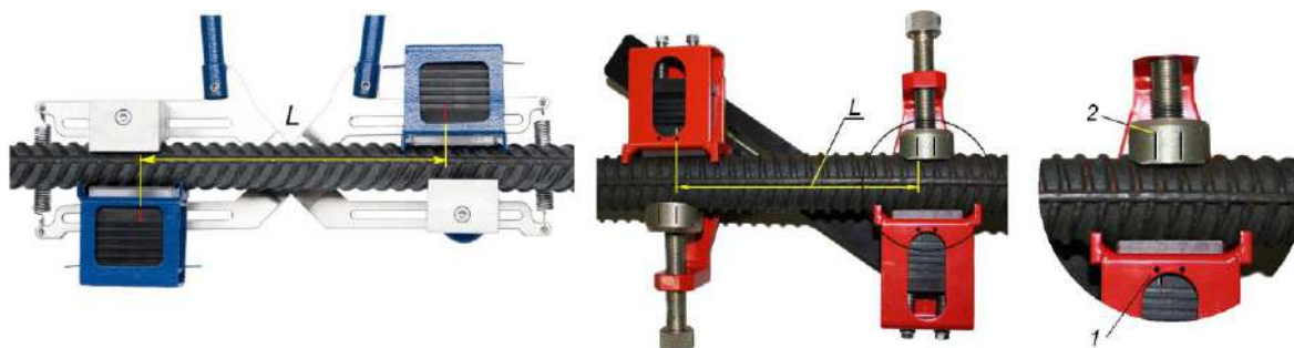
Рисунок 1.3 – Расположение ПЭП на арматурном стержне при теновом методе контроля
