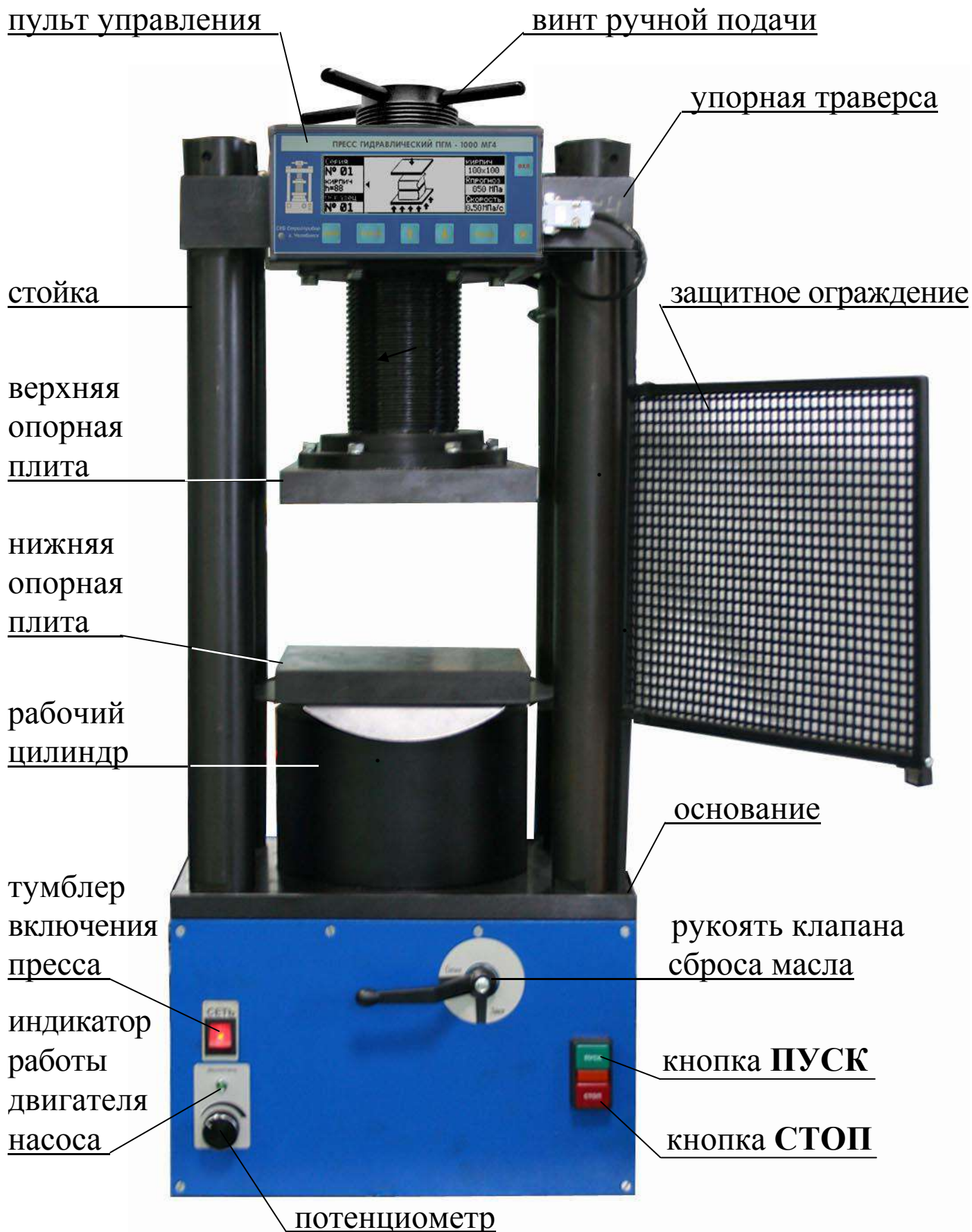
Рисунок 1.а – Внешний вид пресса. Вид спереди
