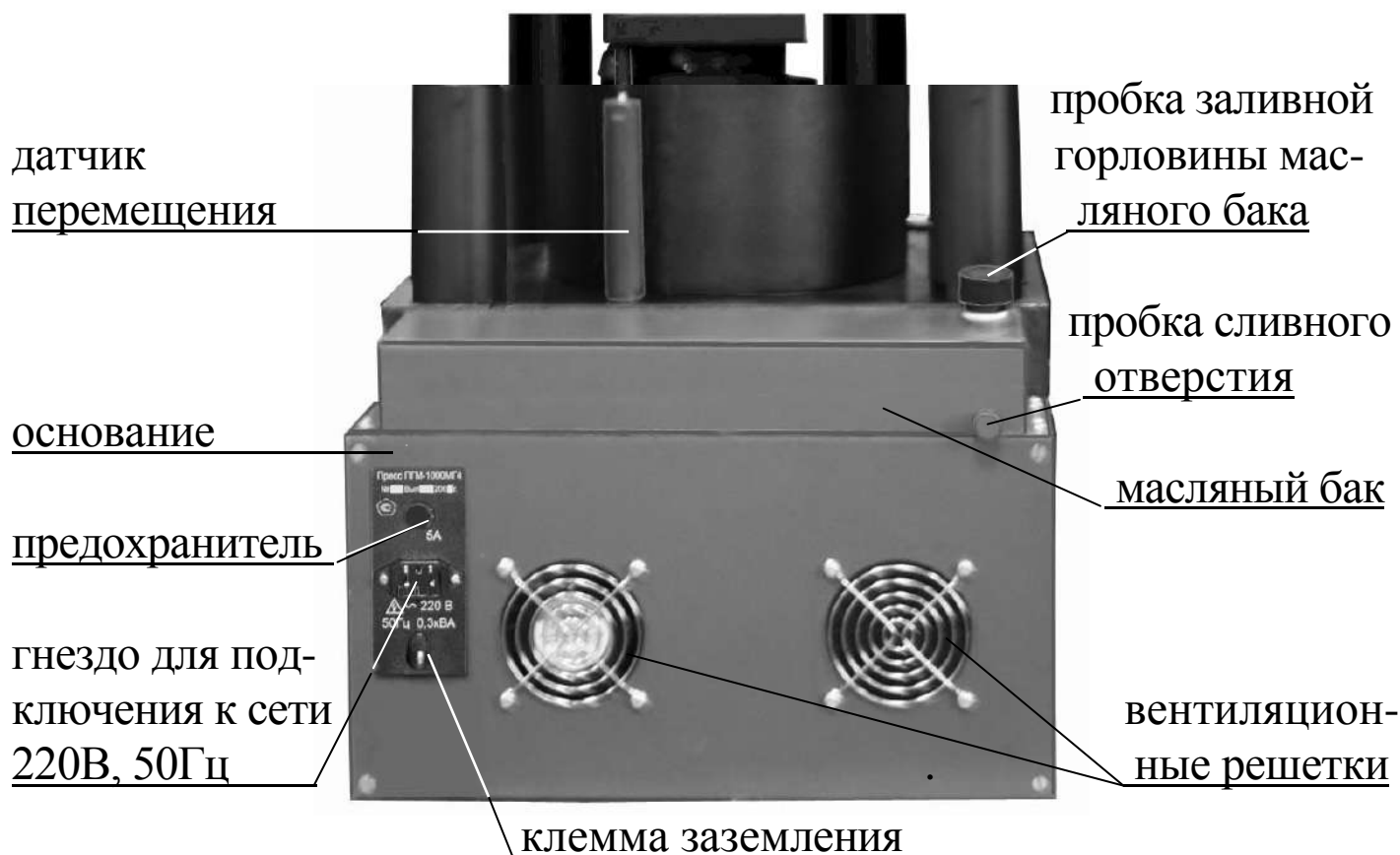
Рисунок 4.1.б - Внешний вид пресса. Вид сзади
